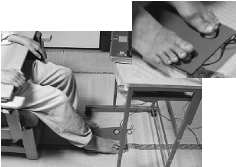
足でパソコンを操作するためのインターフェイス。マウスと同じ様に使える。
